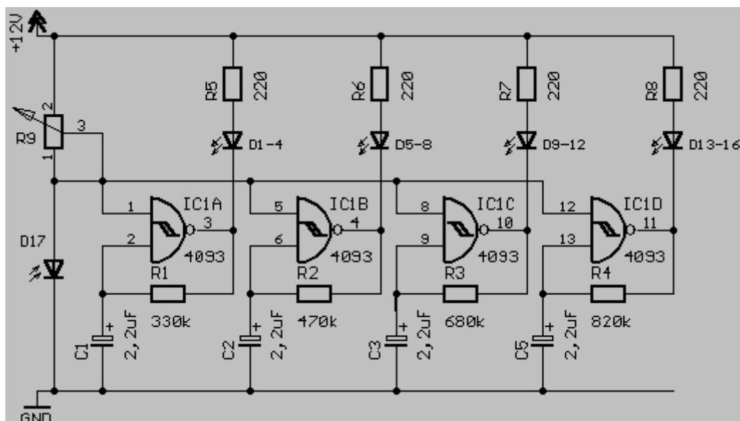
Ich empfehle Ihnen gleich alle Leitungen, einschließlich der Plus Leitungen für die Anoden, an die Platine anzuschließen und in einem verdrehten Strang, der den Stamm darstellt, nach oben zu gehen und immer mehrere LEDs auf einmal vom Stamm wegzuführen. Weiterhin empfehle ich braunen Draht(nicht Litze) zu verwenden und die LEDs der verschiedenen Takte gut zu verteilen, damit der Effekt richtig wirkt.
